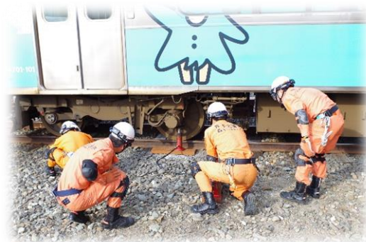
油圧ジャッキを使用した車両上げ
